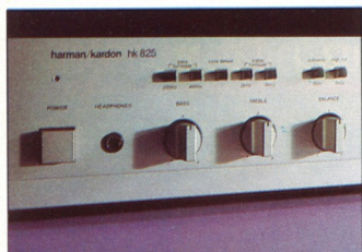
Tra gli extra del preampli figurano i selettori di «turnover» dei toni ed i filtri subsonico e degli alti.
