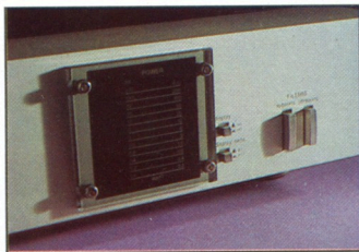
Accanto al wattmetro a LED del finale, i relativi pulsanti e quelli di inserimento dei filtri.
